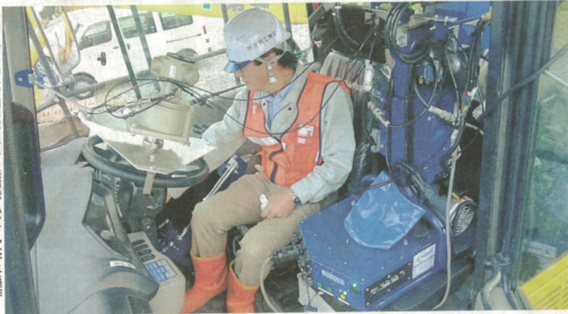
ダンプの助手席側に取り付けた装置がハンドルなどを操作する
